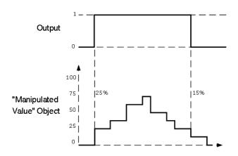
Fig12. Manipulated Value (1 Byte)
